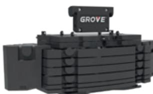
Ses configurations de contrepoids permettent de faire varier l'installation entre 0,8 t de contrepoids et de 12 t à 16,5 t par essieu en configuration taxi. Vous obtenez ainsi une meilleure maniabilité et traction sur route et réalisez des économies de déplacement.
